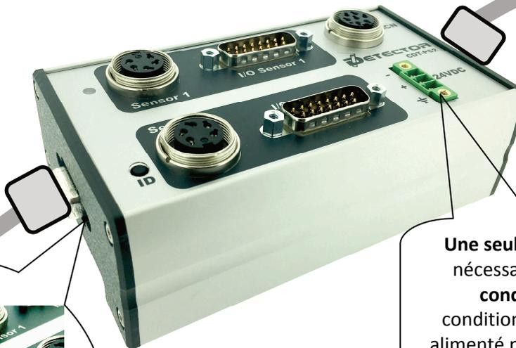
**Une seule alimentation** est nécessaire sur le **premier conditionneur**. Les conditionneurs suivant sont alimenté par la connexion **BUS**
