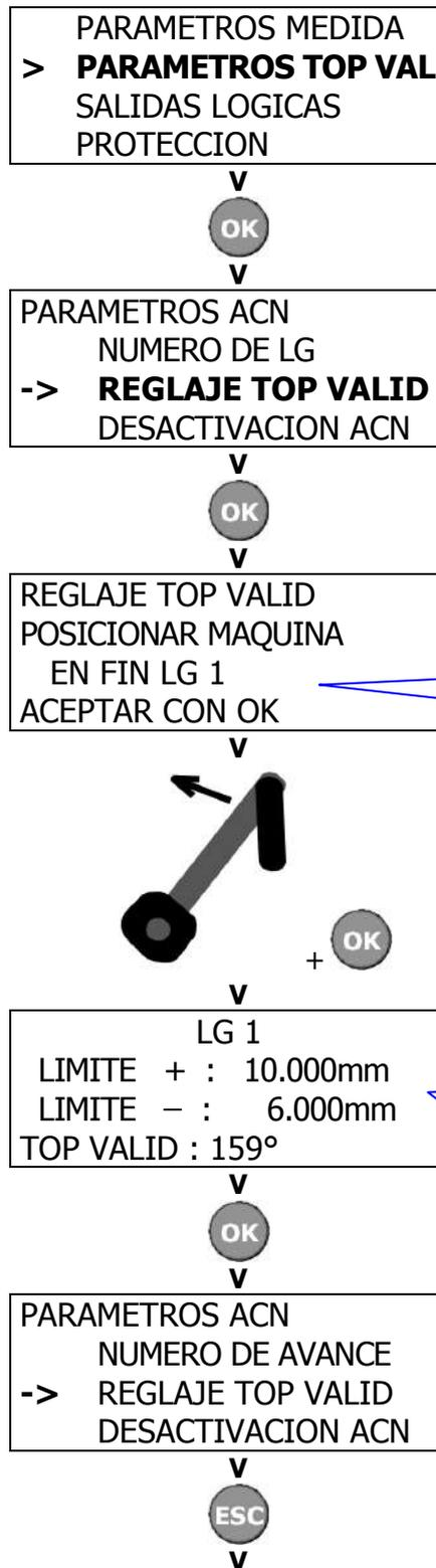
Posicionar la máquina manualmente al final de la **1ª longitud**
