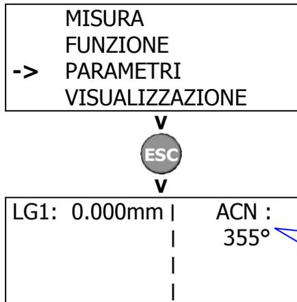
La posizione dell'albero a camma è digitalizzato e può essere visualizzato nell'angolo alto a destra.
